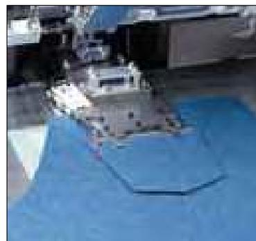
**Figure 10.4:** Hip Pocket Automaton ([www.astasjuki.com](http://www.astasjuki.com))
