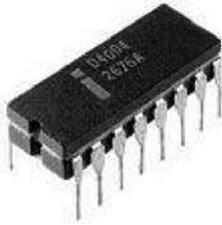
Figure 1.4 The Intel 4004 processor. (Image from [www.thg.ru/cpu/20051118/index.html](http://www.thg.ru/cpu/20051118/index.html), retrieved 9 Jan 2009.)
